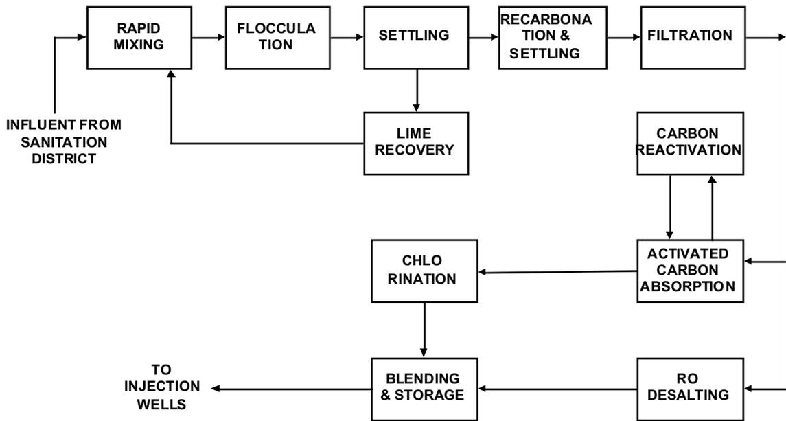
WATER FACTORY 21 WASTEWATER RECLAMATION SYSTEM FLOW DIAGRAM
